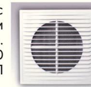
**Серия «РСФ»:** Решетки с горизонтальными прямыми жалюзи и фланцем. Используются при монтаже с круглыми и прямоугольными каналами. Размерный ряд: 1515РС10Ф (Ø100, 150x150 мм), 1717РС12,5Ф (Ø125, 170x170 мм), 2020РС16Ф (Ø160, 200x200 мм), 620РСФ (размер фланца - 60x204 мм), 612РСФ (60x120 мм). Прямоугольные решетки РСФ крепятся к каналу через фасонный соединитель 612РСФ и 620 РСФ.
