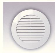
**Серия «МЭ/МЦ»:** Решетки с горизонтальными наклонными жалюзи и антимоскитной сеткой. Изготовлены из устойчивой к атмосферным воздействиям тонколистовой стали с полимерным покрытием (МЭ), с цинковым покрытием (МЦ). Размерный ряд: 1212МЭ/1212МЦ (125x125 мм), 1515МЭ/1515МЦ (150x150 мм), 2020МЭ/2020МЦ (200x200 мм), 2525МЭ/2525МЦ (250x250 мм), 3030МЭ/3030МЦ (300x300 мм).
